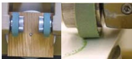
**Taber Abraser 5131, Draufsicht auf Rollen und Probe (links), Detail einer Reibrolle (rechts)**
